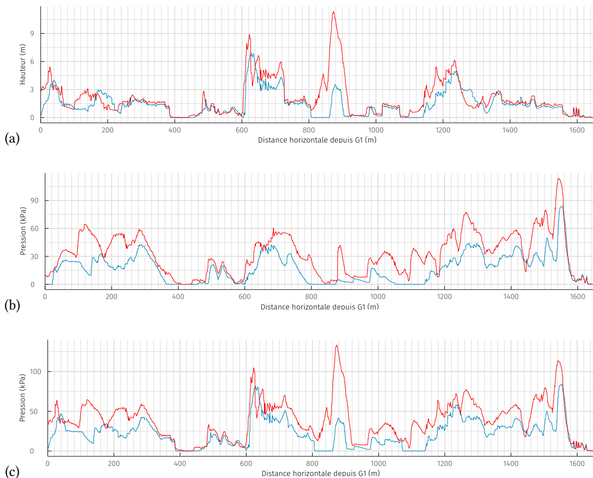
Figure 3.6 – Variation de (a) la hauteur d'écoulement, (b) la pression cinétique, et (c) la pression maximale – calculée selon l'équation (3.1) – le long de la ligne du TSD pour des avalanches naturelles T = 30 ans (trait bleu) et T = 100 ans (trait rouge).
